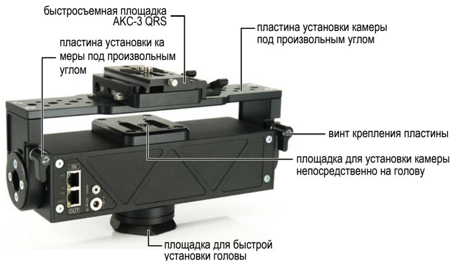
Голова MONO HEAD снабжена разъемом TRIGGER. Подключая фотокамеру к этому разъему, с помощью спускового тросика осуществляется синхронизация спуска затвора камеры и движения головы, что позволяет снимать Timelaps или интервальную фотосъемку.
